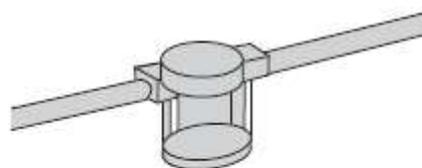
Топливный фильтр котла следует заменять 1~2 раза или более в год, равно как масляный фильтр в машине следует менять каждые 3 месяца.
