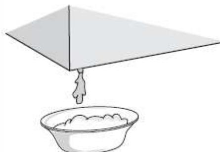
Пожалуйста, удаляйте остатки воды внутри верхнего резервуара для топлива, по крайней мере, раз в год.
