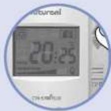
Если не загорается, удалите воздух из топливной трубы/газовой трубы и нажмите кнопку включения/кнопку повторного функционирования на регуляторе температуры в помещении.
