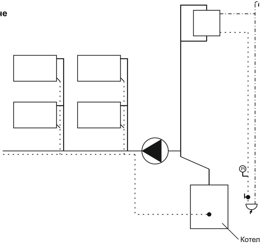
Расширительный бак открытого типа должен быть размещен в верхней точке системы отопления.
